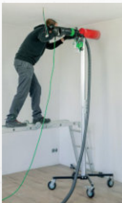
Podna vodilna kolica za brusilicu EBS 125/1802/180
